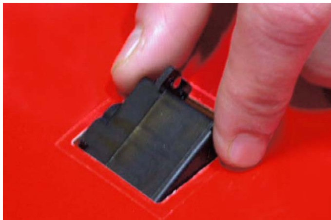
Fig.56: Inserire il servocomando nella semi-ala.
