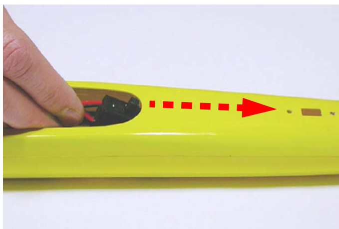
Fig.28: Inserire l'interruttore ON/OFF.
