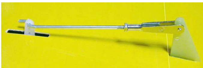
Fig.66: Asta di rinvio in posizione.
