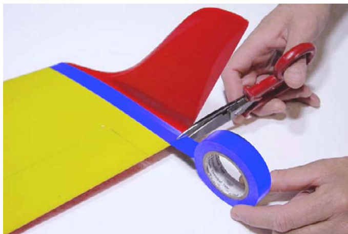
Fig.73: Tagliare il nastro lungo il bordo d'uscita.
