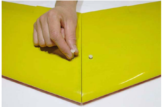
Fig.69: Inserire le viti di Nylon.
