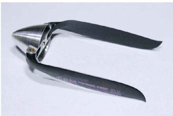
Fig.17: Gruppo elica montato.
