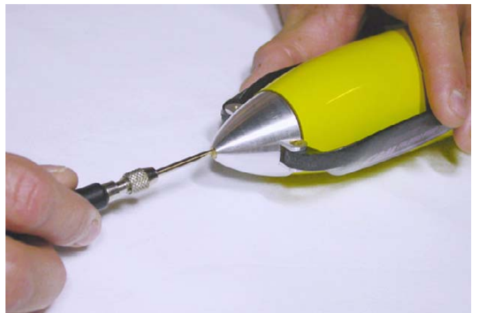
Fig.19: Fissare l'ogiva al mozzo.
