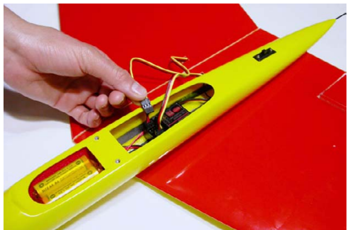
Fig.70: Collegamento dei servocomandi.
