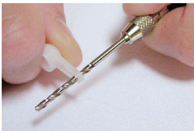
Fig.44: Allargare il foro più esterno della squadretta.
