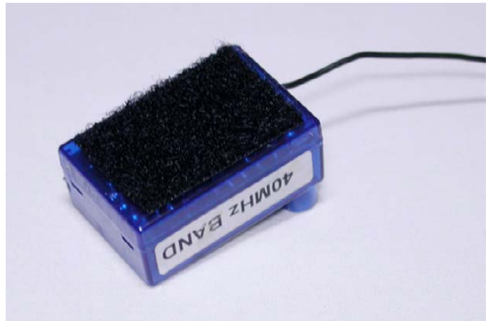
Fig.10: Velcro incollato all'apparato ricevente.
