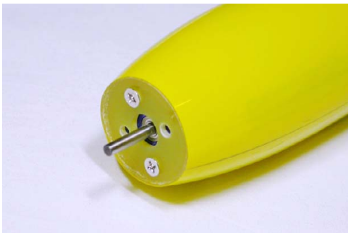
Fig.16: Avvitare il motore alla struttura.
