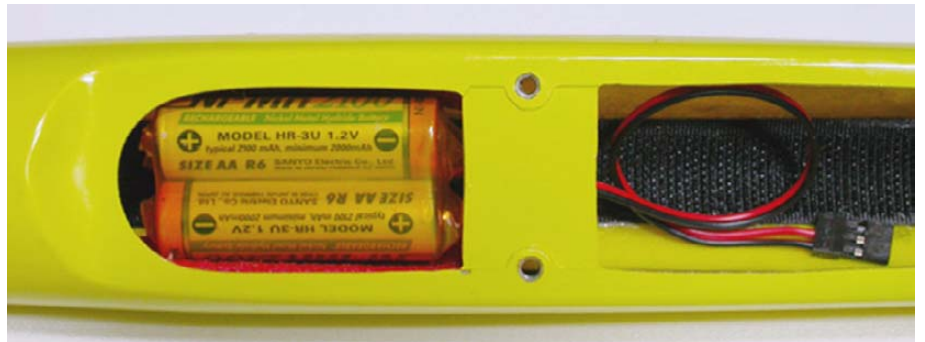
Fig.30: Batterie in posizione.
