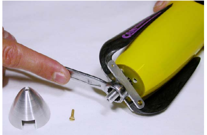
Fig.18: Serrare l'elica sull'albero motore.
