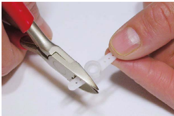
Fig.43: Troncare una delle leve delle squadrette.
