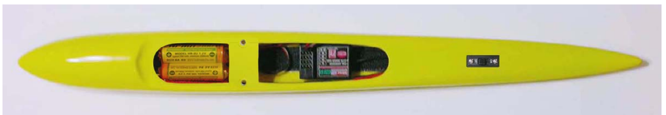
Fig.32: Disposizione dei componenti nella versione aliante.
