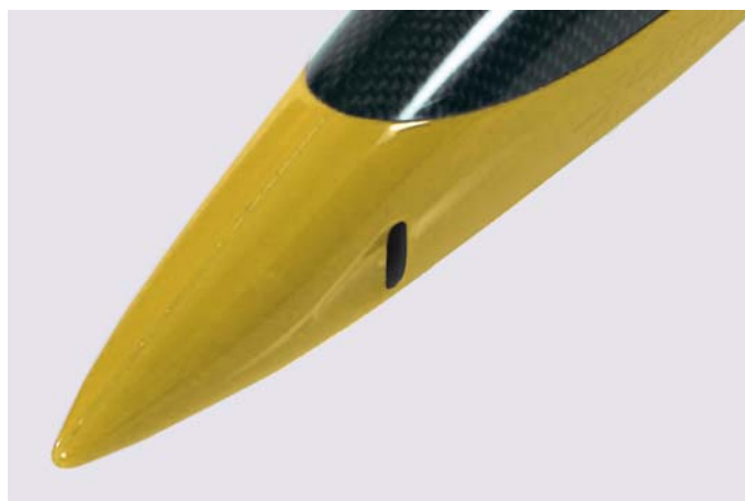
Fig.42: Apertura dei fori per il raffreddamento.
