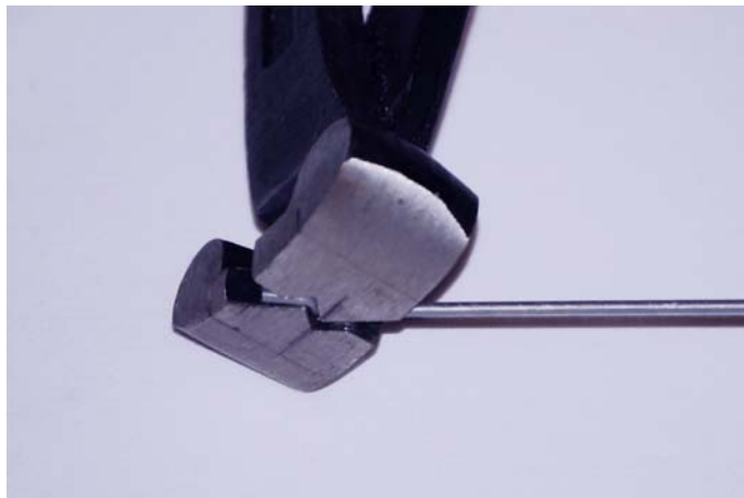
Fig.29: Piegare un'estremità dell'asta di rinvio.
