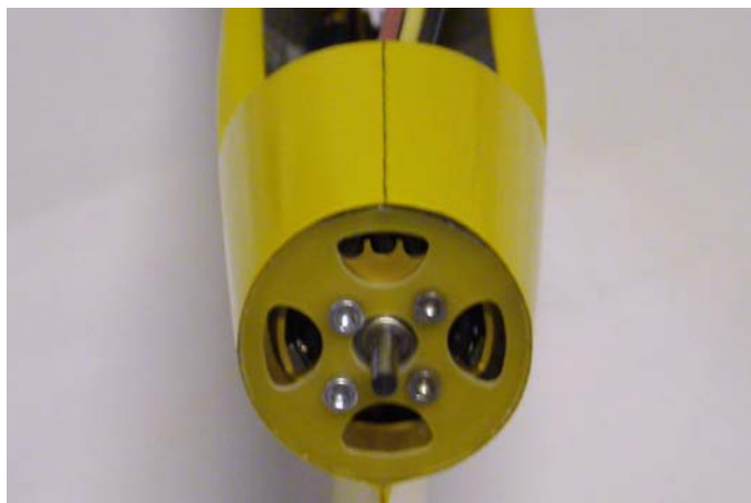
Fig.17: Avvitare il motore all'ordinata.
