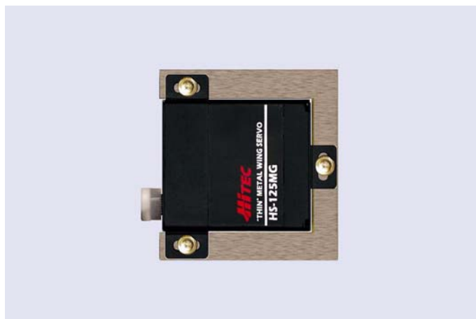
Fig.45: Servocomando fissato al proprio supporto.
