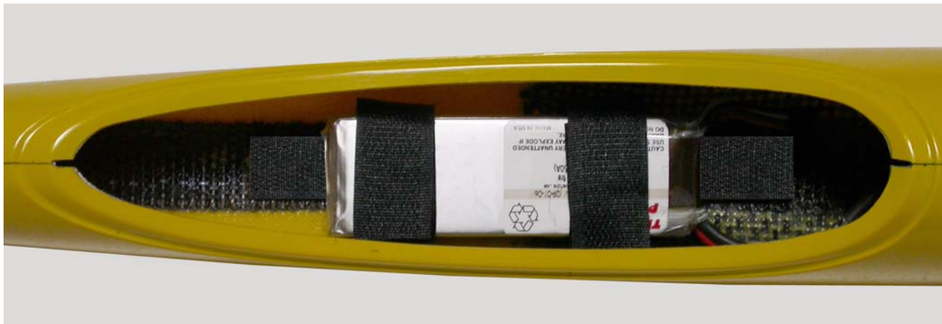
Fig.26: Inserimento e ancoraggio del pacco batterie.
